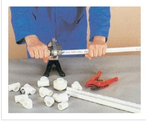
2. Boru ve ekleme parçası 260° C'deki kaynak makinasında ısıtılır.
